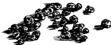
Die Blähton-Trockenschüttungen sind der schall- und wärmedämmende Unterbau für Fußböden, die stark belastet werden. Sie zeichnen sich durch hohe Stabilität bei geringem Gewicht aus.
